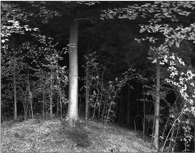
Abb. 3: Ergebnisse des Vermessungsvorgangs: Intensitätsbild (links) und Punktwolke der dreidimensionalen Koordinaten (unten aus anderem Blickwinkel)
