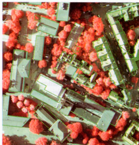
Abb. 6: CIR True-Ortho-Bild mit überlagerten Gebäudevektoren.
