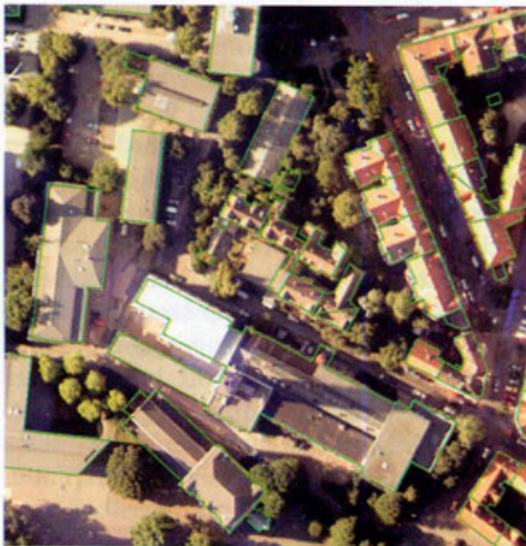
Abb. 5: RGB True-Ortho-Bild mit überlagerten Gebäudevektoren.
